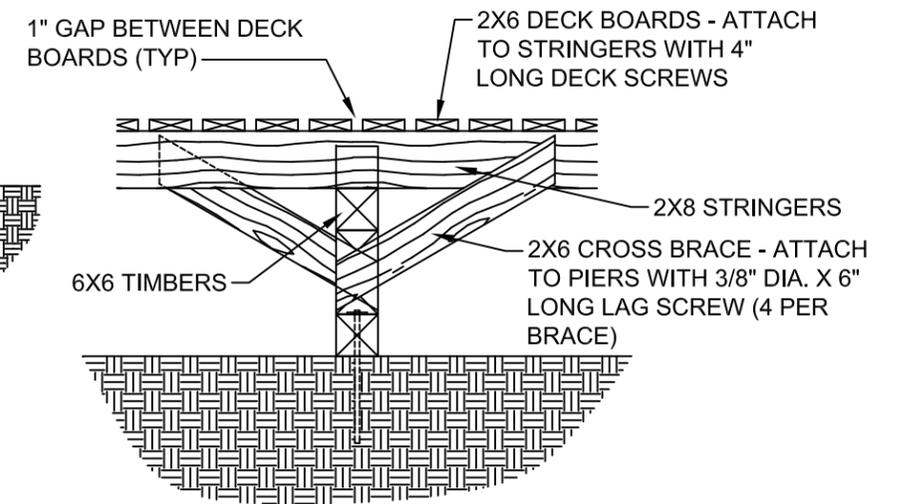
**TYPICAL ELEVATION @ PIER LOCATION**
