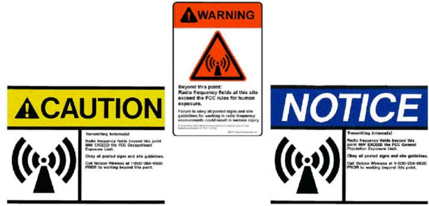
E RF WARNING SIGNS SCALE: NTS
