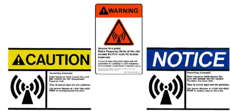
E RF WARNING SIGNS SCALE: NTS
